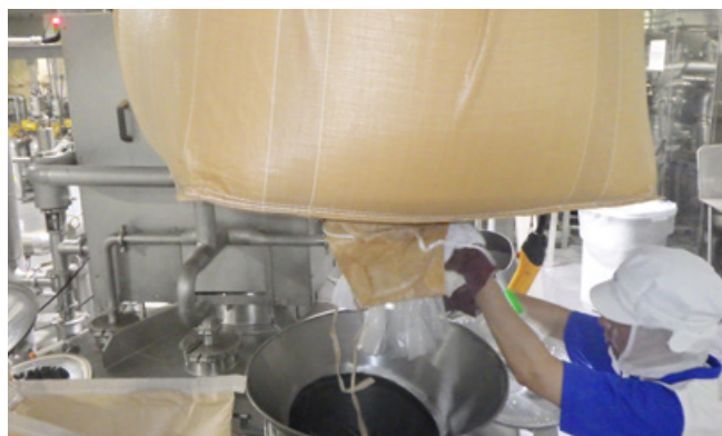
クレーンを用いフレキシブルコンテナバッグから粉乳を投入する様子
