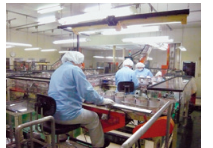
ミルク缶製造ライン 内外面検査室
