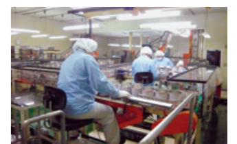
ミルク缶製造ライン 内外面検査室
